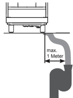
Lochdurchmesser 70mm für Wassereingang und -ablauf. Auch für Netzkabel möglich.
